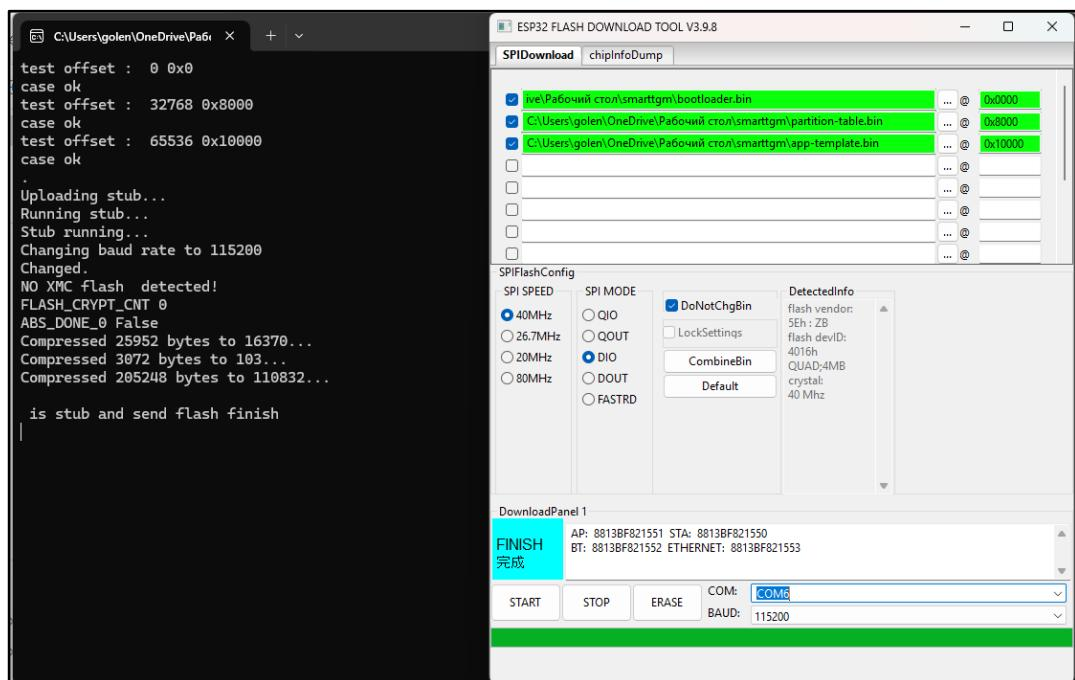
Рисунок 13 – Настройки загрузки и успешное обновление микропрограммы прибора
