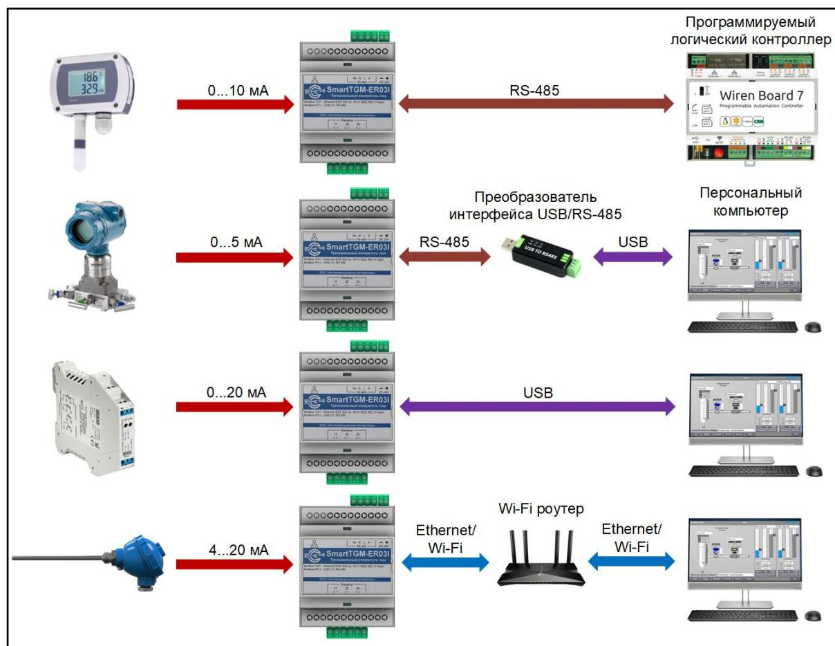
Рисунок 1 – Пример использования модуля с управляющим устройством
