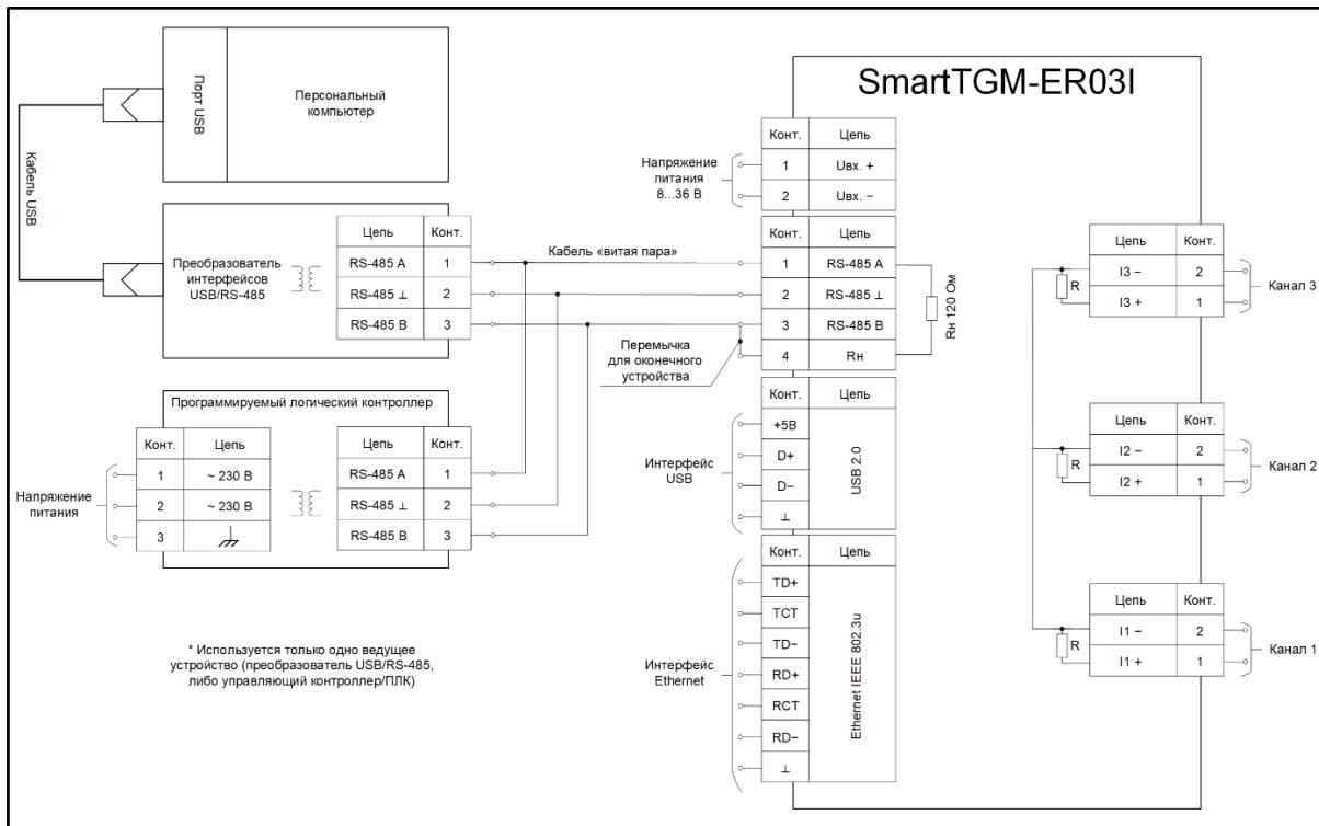
Рисунок 2 – Схема подключения прибора по интерфейсу RS-485
