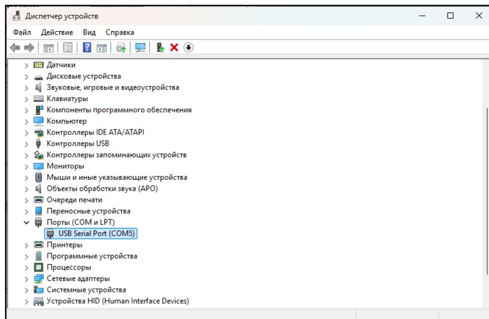
Рисунок 6 – Поиск устройства в диспетчере устройств ОС Microsoft Windows
