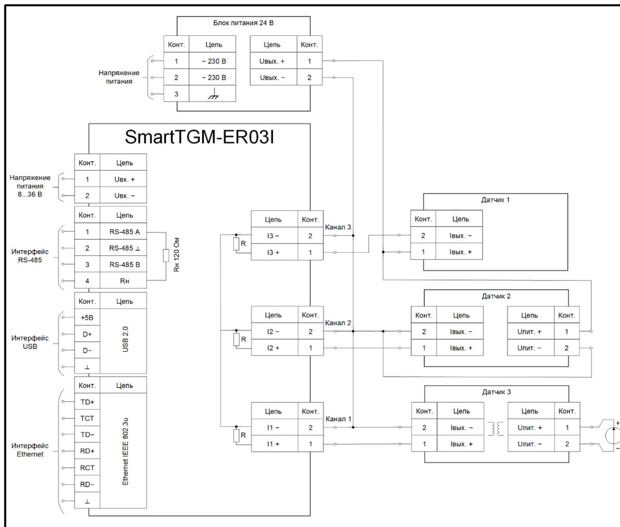
Рисунок 1 – Схема подключения каналов измерения прибора к датчикам
