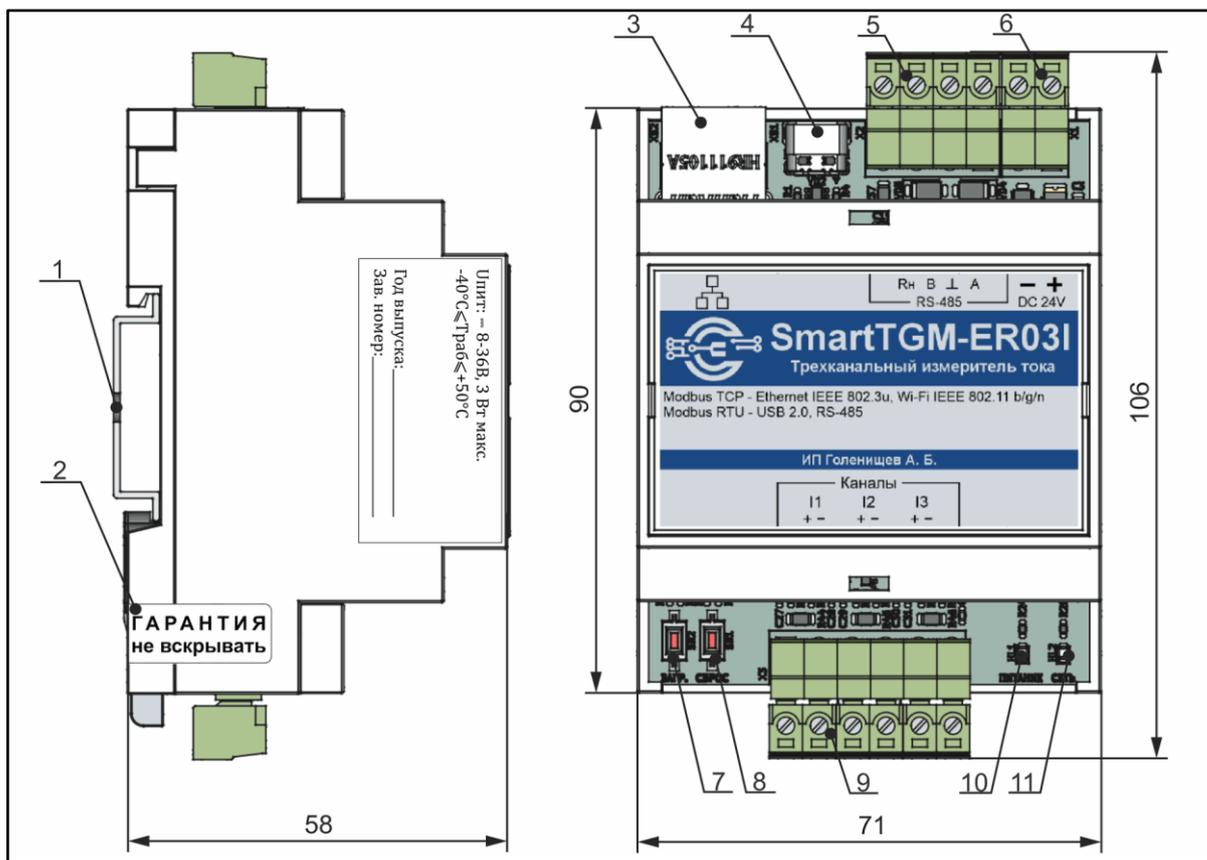
Рисунок 3 – Габаритные размеры и индикация прибора
