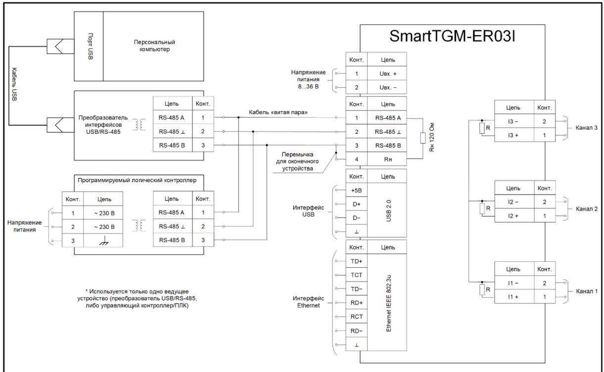
Рисунок 2 – Схема подключения прибора по интерфейсу RS-485 к ведущему устройству
